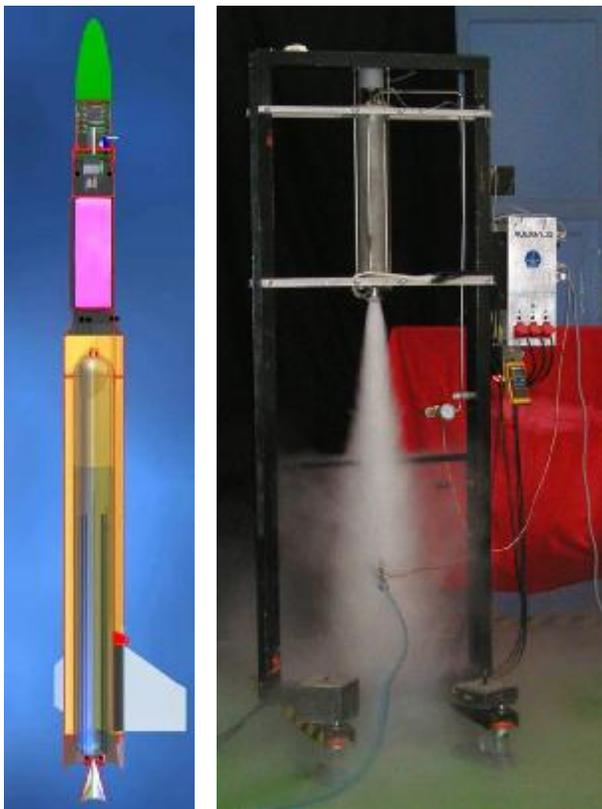
Aufbau einer einstufigen Heißwasserrakete (links) und Prüfstandsversuch (rechts)
